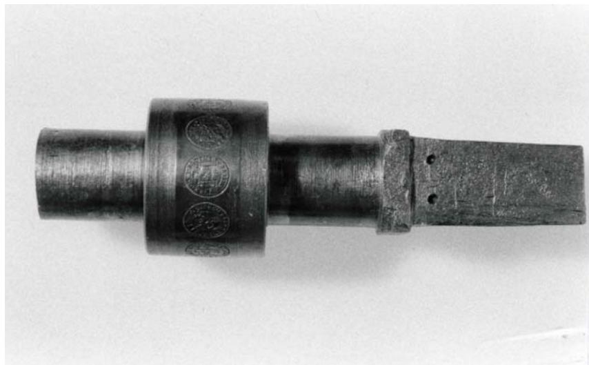
Prägewalze aus Eisen mit dem Negativbild der Vorderseite von 10 Bluzgern des Bistums und der Stadt Chur, die abwechslungsweise graviert sind (1766).
